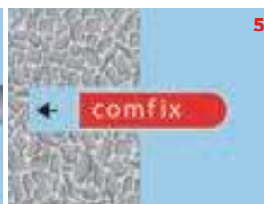
5 Размещение анкера капсульного типа в очищенное отверстие
