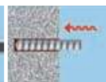
Вкручивание металлической шпильки и ожидание отверждения
