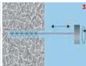
3 Очистка отверстия стальной щеткой 4-6 раз
