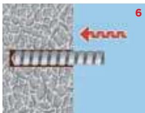
6 Вкручивание шпильки в ударном режиме на 1000 об/мин
