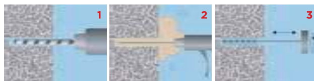
1 Сверление отверстия ударной дрелью 2 Продувка отверстия сжатым воздухом 3 Очистка отверстия стальной щеткой 4-6 раз
