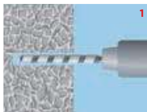
1 Сверление отверстия ударной дрелью
