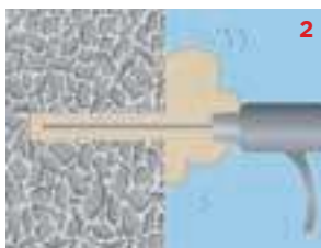
2 Продувка отверстия сжатым воздухом
