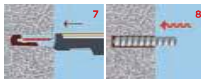
7 Заполнение отверстия от дна к устью, примерно на две трети объема 8 Вкручивание металлической шпильки и ожидание отверждения
