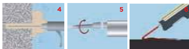
4 Повторная продувка отверстия 5 Установка на картридж пластикового носика-смесителя 6 Установка картриджа в пистолет. Нанесение небольшого количества смеси
